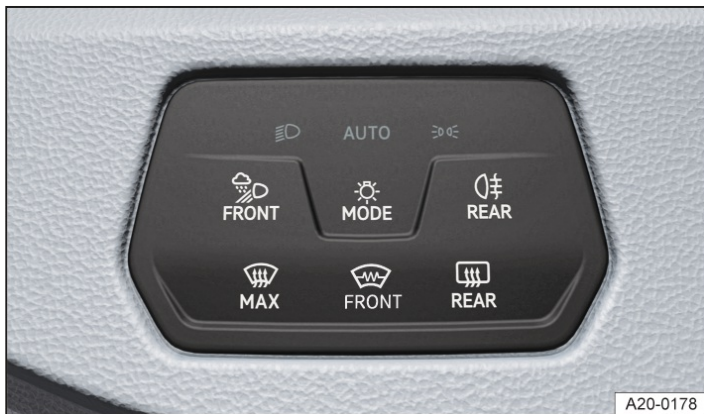
Fig. 1 Ved siden af rattet: betjeningspanel til tænding af udvendigt lys
