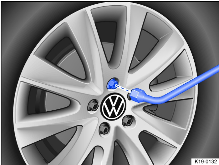
Fig. 1 Hjulskift: Sådan skrues hjulboltene ud med hjulnøglen.
